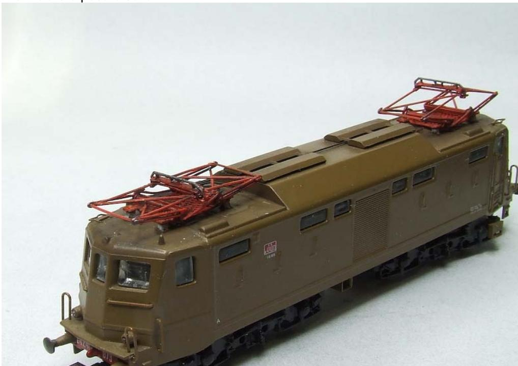
Per il posizionamento sulla macchina sarà necessario eliminare con un cutter gli apooggi esistenti in modo da abbassare al massimo la base sul tetto. La posizione sarà determinata dagli isolatori esistenti.
