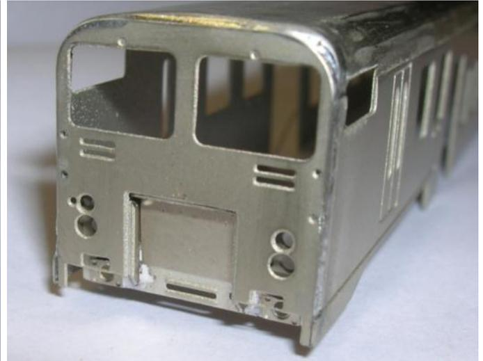
Infine si salda la linguetta di appoggio del telaio, incastrandola all'interno delle apposite fessure
