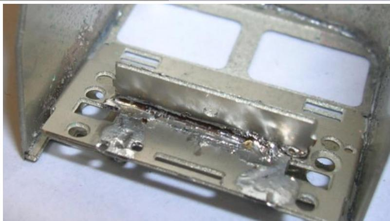
Non vi preoccupate se occludete i fori per gli accoppiatori, li ripasseremo più tardi con una punta. Il kit IR Model permette la configurazione delle porte "a filo" cassa o in posizione "interna".
