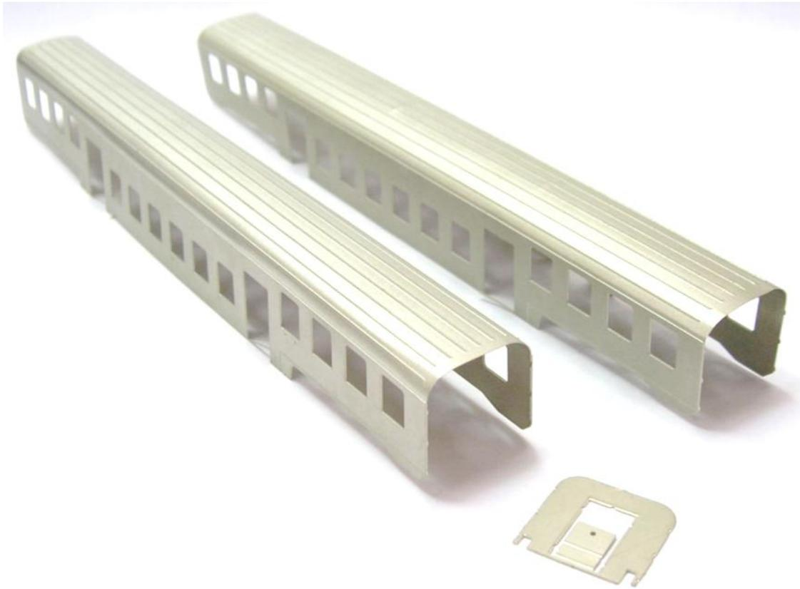
Fatto ciò, si può procedere con la saldatura delle testate, che vanno allineate utilizzando gli appositi riscontri.
