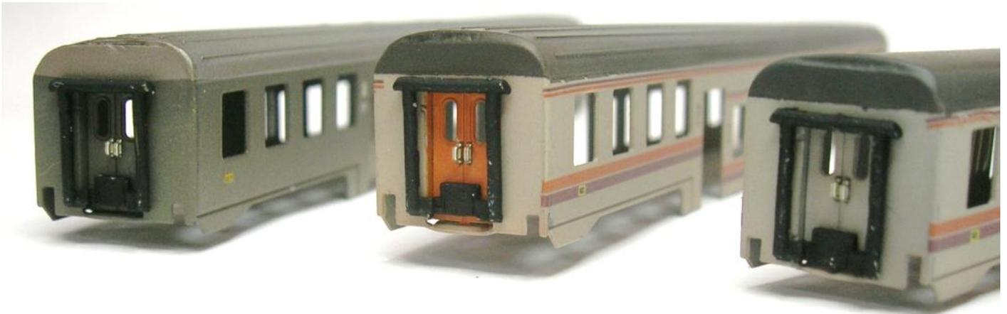
Completa la lista dei dettagli l'applicazione del mancorrente centrale nelle porte incassate della carrozza semipilota (dettaglio visto in una foto del già citato libro "Carrozze FS – Volume 2"). Ho realizzato i mancorrenti con filo d'acciaio armonico  $\varnothing 0.5$  mm e li ho incollati con colla cianacrilica
