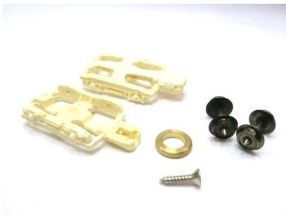
Con uno spazzolino a setole medio/dure ho rimosso i residui delle bave di stampaggio. Con un cutter ho allargato le sedi dove gireranno le ruote, per evitare ogni contatto tra i bordini e le fiancate interne dei carrelli stessi.
