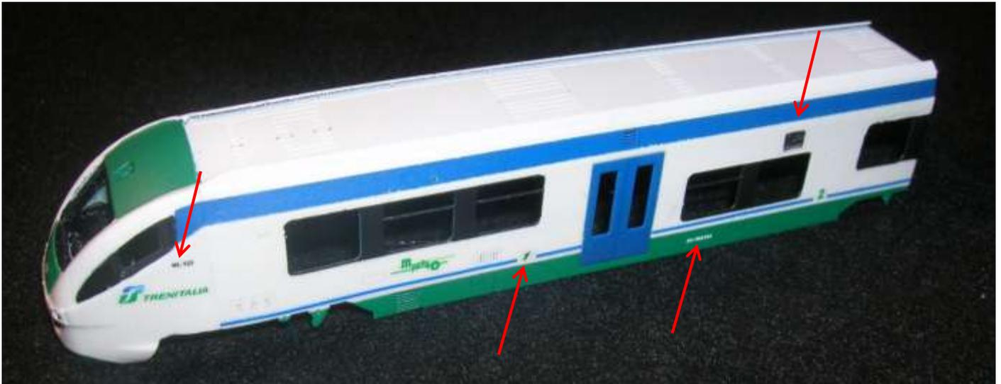
Dopo aver posizionato le decals, ho dato una mano di trasparente opaco, per evitare ogni possibile distacco durante le successive operazioni di finitura.
