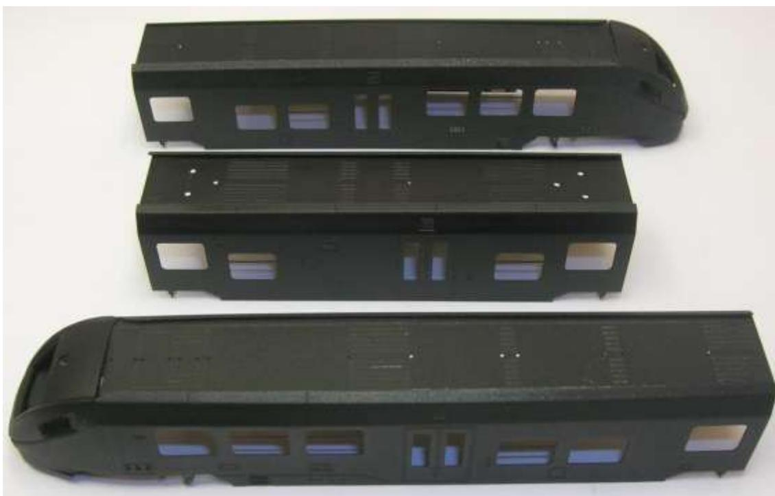
Per l'applicazione della livrea Trenitalia (XMPR) ho utilizzato le mascherature gentilmente fornitemi da Stefano, tagliate con un plotter apposito già nelle corrette dimensioni, integrate con del nastro adesivo Tamiya ove necessario.
