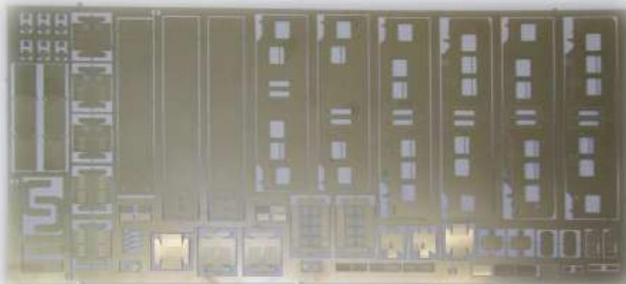
Si comincia dai due soffietti, che saranno assemblati insieme al telaio. Sono composti da tre pezzi, che devono essere piegati e saldati a stagno tra di loro
