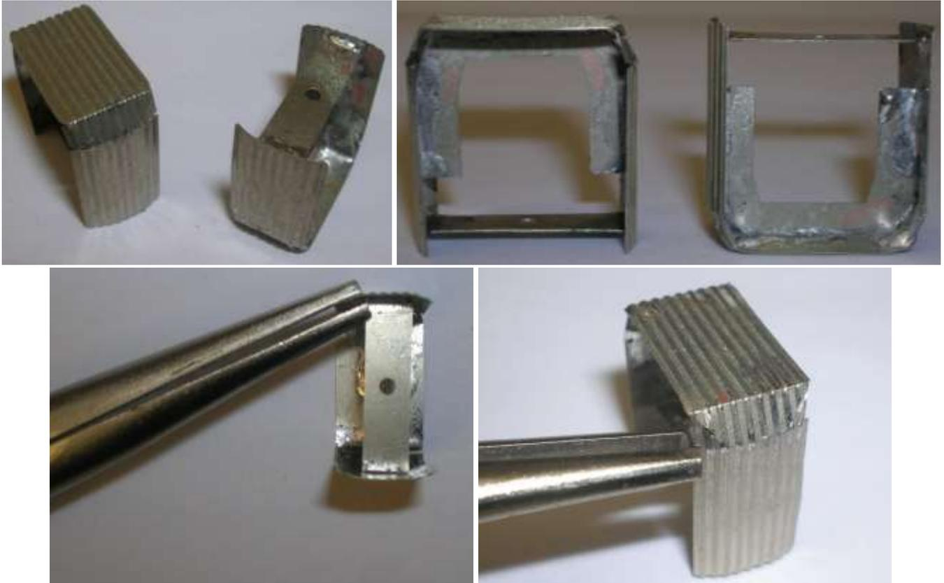
Una sgrassata nello “Smac Gas” ed un successiva verniciatura con bomboletta spray di colore nero opaco completano i due soffietti. Li ho verniciati in anticipo in quanto sono assemblati sul telaio.
