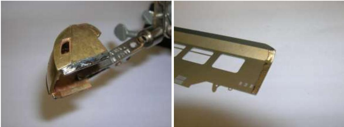
Con l'ausilio di alcune pinzette che serrano fortemente il tutto, si avvicina per pochi secondi la fiamma di un saldatore a torcia (oppure la punta del saldatore elettrico molto calda – circa 450°C) fino a quando lo stagno si liquefa e la saldatura avviene in maniera completa.
