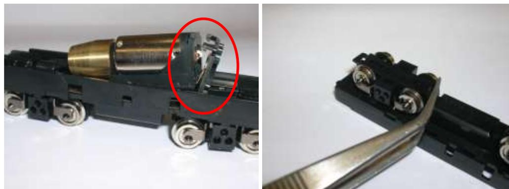
Terminate le operazioni di smontaggio, sul tavolo ci ritroviamo un po' di componenti, che dobbiamo ricomporre nel telaio del Minuetto. Come accennato, per un'alimentazione in DCC, le lamelle prendi-corrente del motore non sono necessarie, quindi si scartano.
