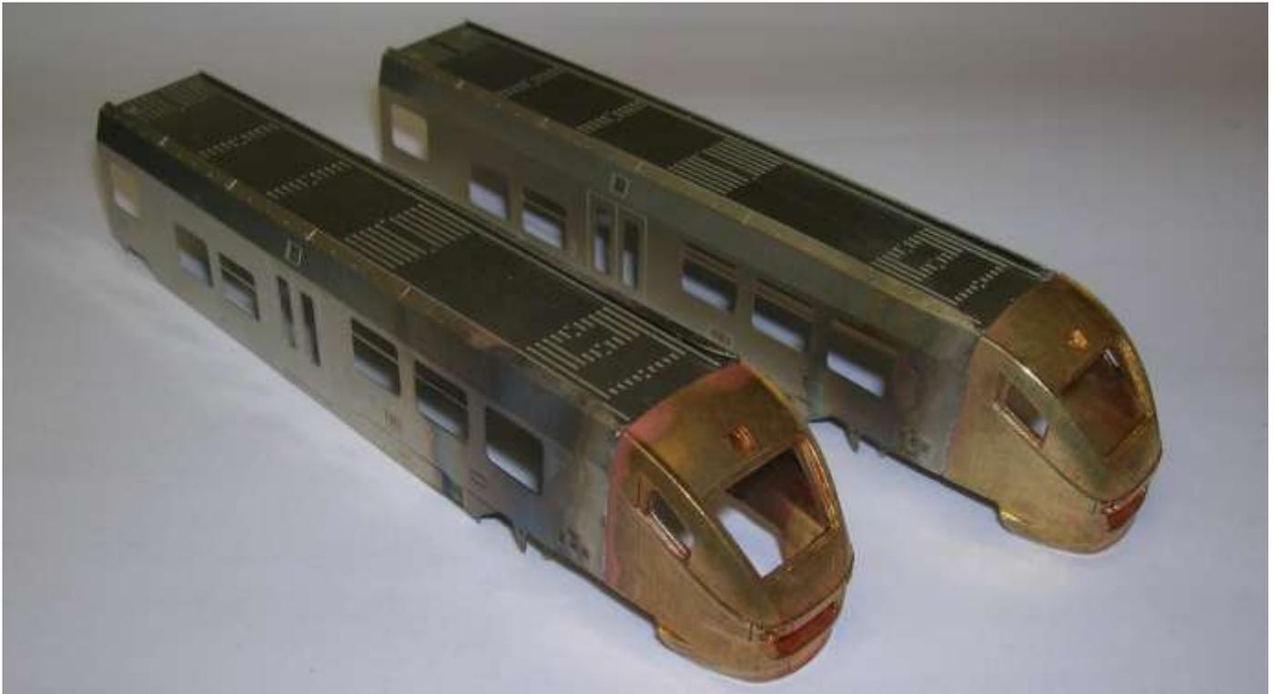
La cassa centrale è formata da due fiancate e dal tetto. Come riscontro per la piegatura e la saldatura, si deve usare una delle due casse d'estremità
