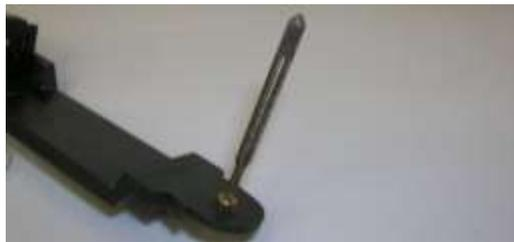
I due carrelli centrali "folli" sono in resina. Si rimuovono i residui e le bave con la punta del cutter.
