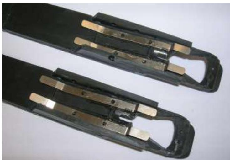
Per facilitare l'inserimento del motore, ho smussato gli spigoli del telaio in corrispondenza degli incastri (piccoli recessi circolari), raschiando con la lama del cutter
