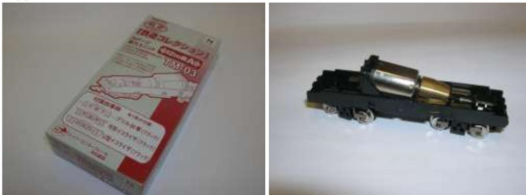
Si sfila il motore (completo di tutto il suo “carter”), l’albero cardanico e le lamelle prendi-corrente dalle ruote. Nel caso di digitalizzazione del modello, le lamelle prendi-corrente del motore devono essere tolte (cerchio rosso nella foto seguente). Poi, con una pinzetta, si rimuove il riparo degli ingranaggi del carrello motore, facendo attenzione a non disperdere sul pavimento i minuscoli ingranaggi, quindi si sfila il carrello comprensivo di vite senza fine.
