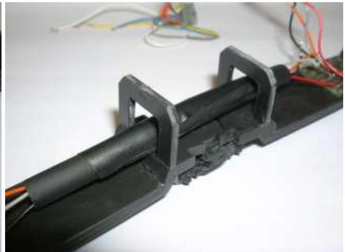
Fatte alcune prove di funzionamento, ho montato correttamente i soffietti verniciati bloccando la vite M2 con un rudimentale frena filetti (un goccio di colla vinilica).
