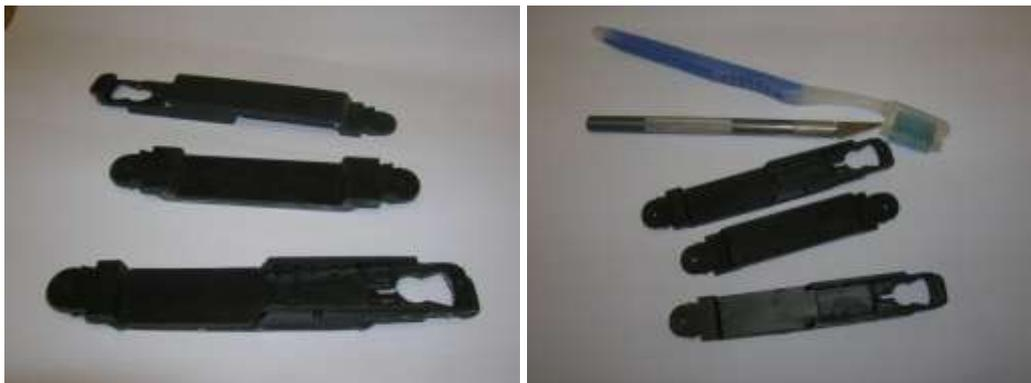
Il Minuetto di Trenomodel ha due carrelli motori, quelli alle estremità. Quelli centrali, invece, sono “folli”. Il gruppo motore (uno per carrello) si ricava dalla motorizzazione Tomytec TM-03. Occorre dunque rimuovere il gruppo dal telaio e rimontarlo nel Minuetto.
